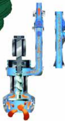
Skruvpump med flexibel stator för driftsäker funktion
